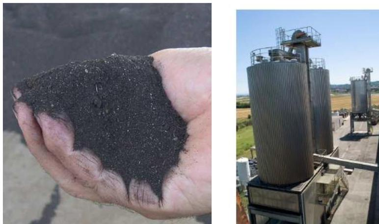
Figura 44. a) Immagine del materiale in uscita dagli essiccatori; b) silos di stoccaggio fanghi essiccati e fertilizzanti
